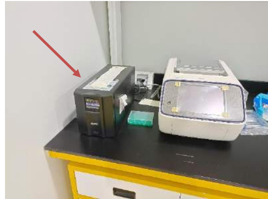
Pemakaian UPS untuk alat Laboratorium
